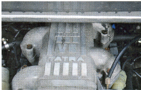
Pod masivní hliníkové sání s logem Tatra V8 je vyvedeno osm vstřikovačů
