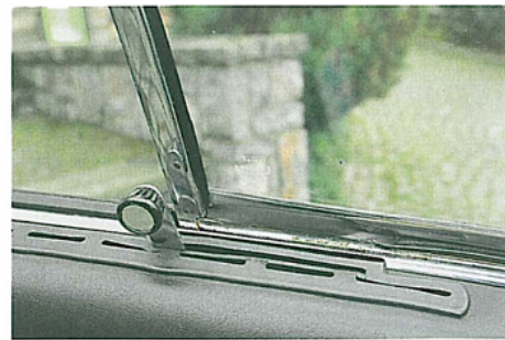
Některé detaily ukazují na tehdejší kvalitu zpracování. Páčkou se otevírá část předního okna.
